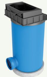
Funke hat einen Straßenablauf entwickelt, dessen Konstruktion alle auftretenden Lasten aufnehmen und über eine Grundplatte in das Erdreich ableiten kann. Der Aufsatz des neuen Funke Straßenablaufs ist in Längs- und Querneigung verstellbar.
