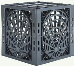
Ein System für den ökologisch sinnvollen Umgang mit Regenwasser, welches nach dem fachgerechten Einbau Niederschlagswasser speichern und sukzessive dreidimensional an das umliegende Erdreich abgeben kann. Die grauen Elemente des Systems bestehen aus PVC-U und verfügen über die Abmessungen: L x B x H: 600 x 600 x 600 mm.
