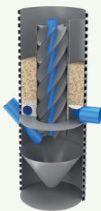
Beim Durchfließen des Filterschachtes werden mehr als 95 % der im Niederschlagswasser enthaltenen Sedimente und Schadstoffe in den verschiedenen Baugruppen des Schachtkörpers zurückgehalten. Das ablaufende Wasser erfüllt die Prüfwerte der Bundesbodenschutzverordnung (BBodSchV) und kann versickern.
